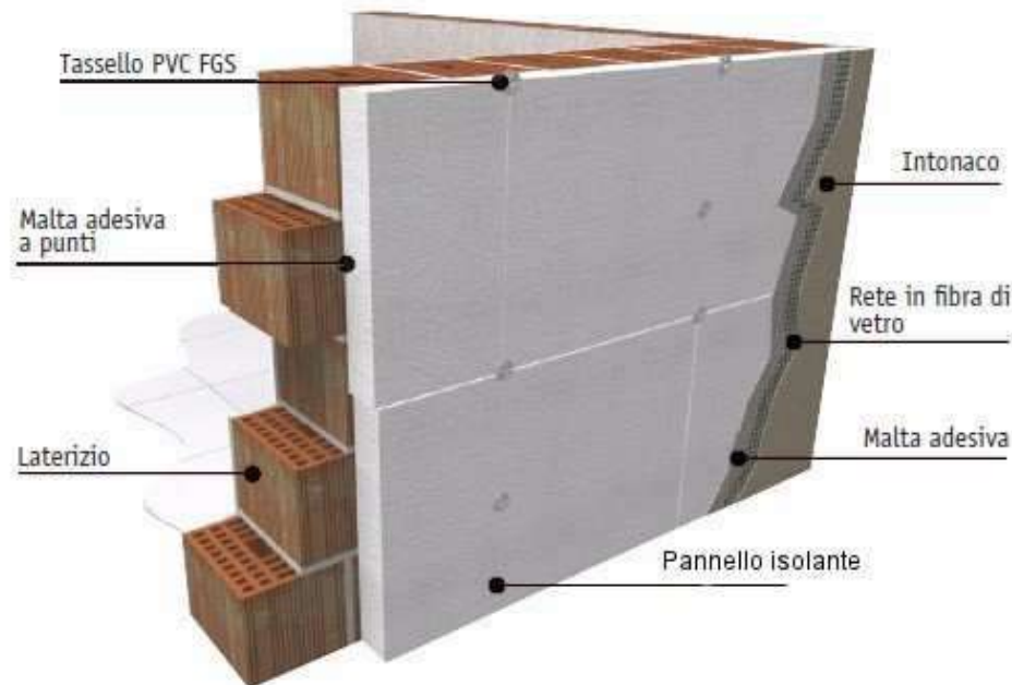
PARTICOLARE MURATURA ESTERNA CON CAPPOTTO
